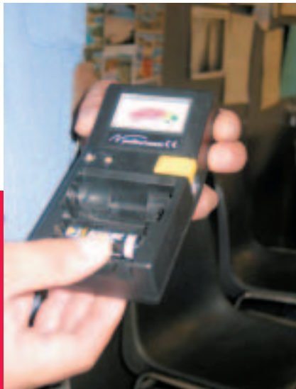
Prüfung der Restkapazität der Batterien
